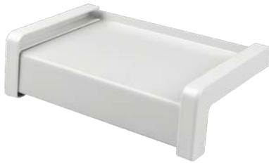
Réalisé en tôle Alcan Globalcolor Prof. 2000 d'une épaisseur de 1,2 mm et revêtu de polyester. Il est possible de fabriquer des seuils d'une longueur maximale de 6 m et leur largeur varie : 90-500 mm.
