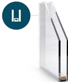
Un vitrage isolant composé de deux vitres scellées. Il s'agit d'un vitrage standard pour les systèmes de base de fenêtres et de portes. L'ensemble de base se caractérise par une épaisseur de 24 mm, est composé des éléments suivants : 4 mm (verre) – 16 mm (intercalaire) – 4 mm (verre), pour obtenir ainsi le vitrage dit 4/16/4.
