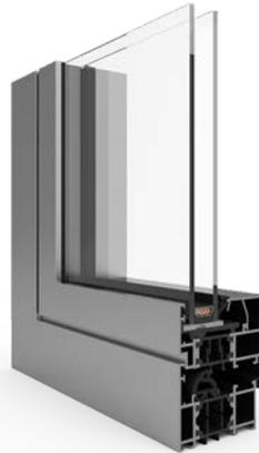
Le profilé est fabriqué en aluminium à l'intérieur et à l'extérieur. Dans la partie centrale, il y a une rupture thermique, ce qui augmente considérablement le pouvoir d'isolation thermique du profilé.
