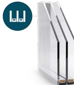
Un vitrage isolant à deux chambres, composé de trois vitres scellées. Il s'agit d'un vitrage standard pour les systèmes de fenêtres et de portes à efficacité énergétique élevée. L'espace entre les vitres, créé par l'intercalaire, est rempli principalement avec de l'argon (90%), ce qui réduit davantage le coefficient de transmission thermique  $U_g$ .
