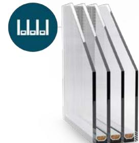
Un vitrage isolant à trois chambres, composé de quatre vitres. Il s'agit d'un choix optimal pour les systèmes de fenêtres et de portes aux meilleures performances thermiques. Le choix de ce vitrage, associé à un intercalaire Swisspacer Ultimate et au krypton comme gaz de remplissage de l'espace entre les vitres, ainsi qu'au système Energeto 8000, permet d'obtenir les meilleures performances thermiques possibles des fenêtres du marché.
