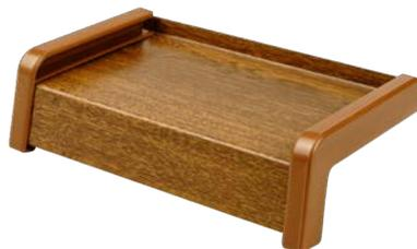
Appui de fenêtre en acier galvanisé recouvert d'une feuille de PVC. Fabriqué à partir d'une feuille de 0,7 mm d'épaisseur avec un revêtement en zinc de 275 g/m<sup>2</sup>. Il est possible de fabriquer un appui de fenêtre jusqu'à une longueur maximale de 6 m et la gamme de largeur est la suivante 100-400mm.
