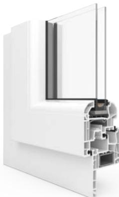
Un profil qui permet d'installer des fenêtres dans des bâtiments existants sans avoir besoin d'enlever les vieux cadres en bois. L'aileton recouvre l'ancien cadre à l'intérieur du bâtiment.
