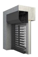
Le système est muni d'un caisson original tronqué à 45 degrés du coté extérieur. C'est une solution idéale pour ceux qui préfèrent les éléments de finition aux formes tranchantes. Ce store peut aussi bien être installé directement sur la façade du bâtiment que dans le renfoncement du châssis de la fenêtre en raison de la forme universelle du caisson.
